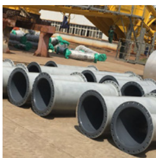
Tubagens para água de lastro
