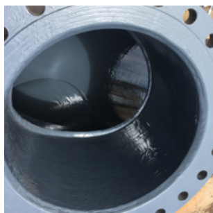
Revêtements de "Scrubber"
