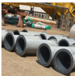
Tuyauteries d'eau de ballast
