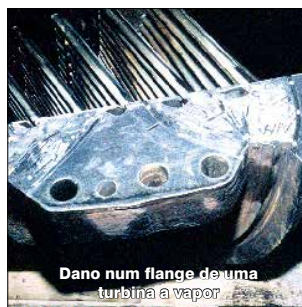
Tratamento cerâmico de um flange
