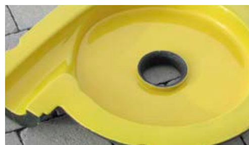
Triste reparación cotidiana: compuesto epoxi pincelado. Ningún técnico avanzado desea volver a ver superficies tan irregulares. “Bien” es otra cosa...
