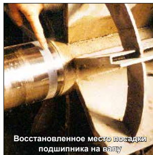
Ролик (вал) с цапфой, на которую устанавливается подшипник перед мех. обработкой
