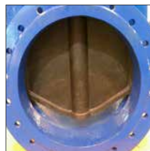
Восстановленная поверхность с использованием керамики
